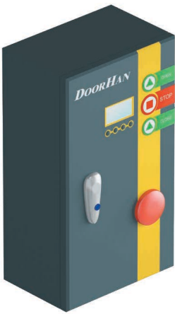
DOORHAN快速门220伏电控系统采用双编码器伺服电机，具有扭矩可调、调试简便的特点，并配有多功能LCD屏幕显示控制箱。
