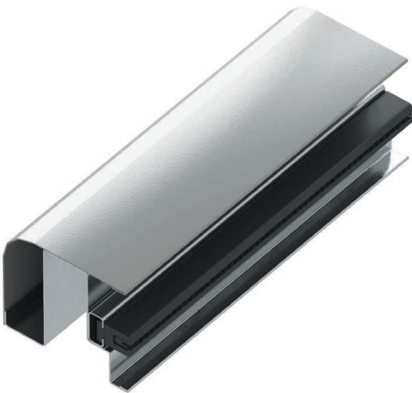
快速门门框由镀锌钢制成，可根据客户需要采用不锈钢材质也可喷涂各种标准颜色，标准化的结构使得更换部件时方便快捷
