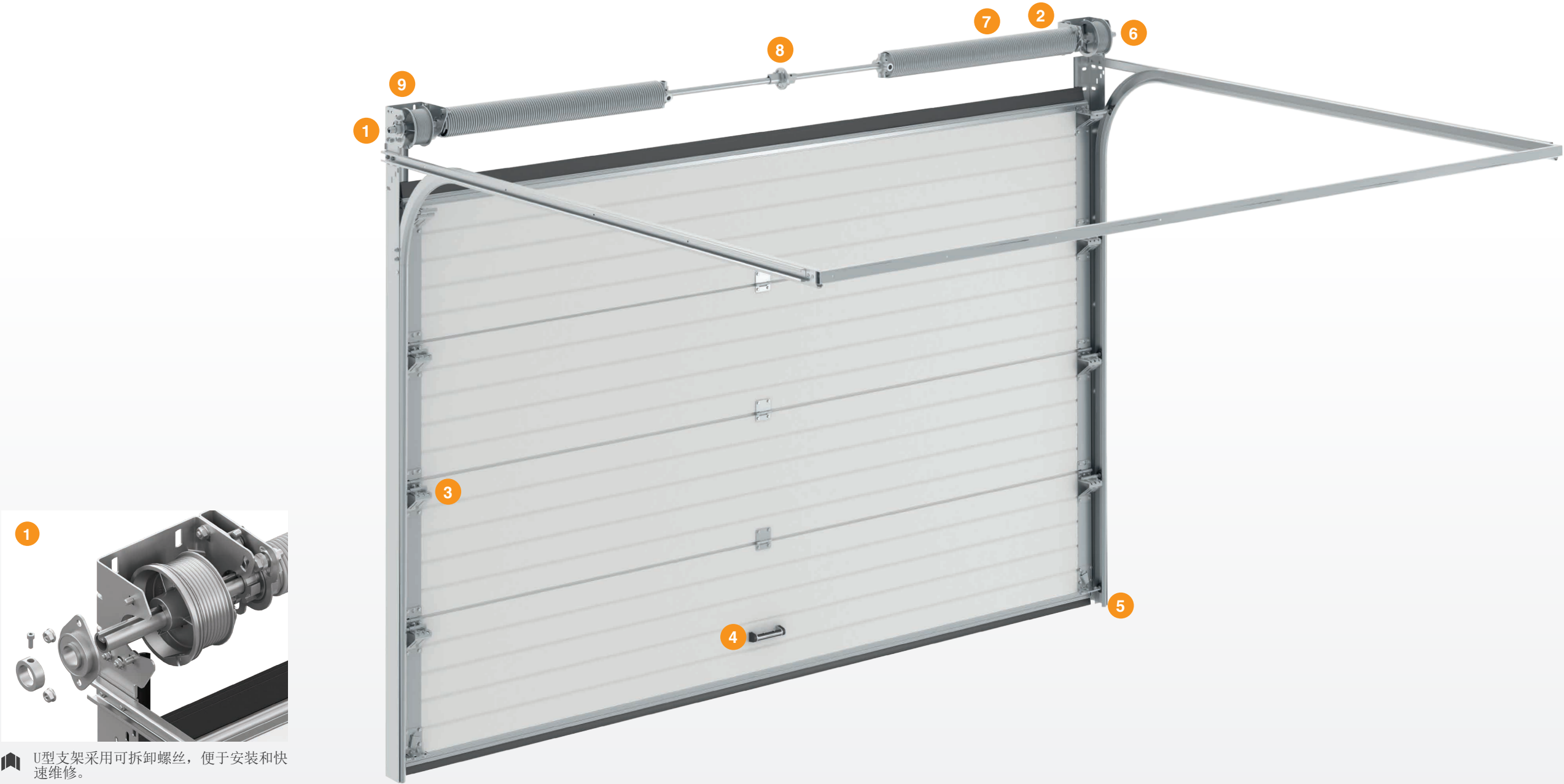
当门楣小于160mm，门体手动运行时，可采用新型的U型支架安装
