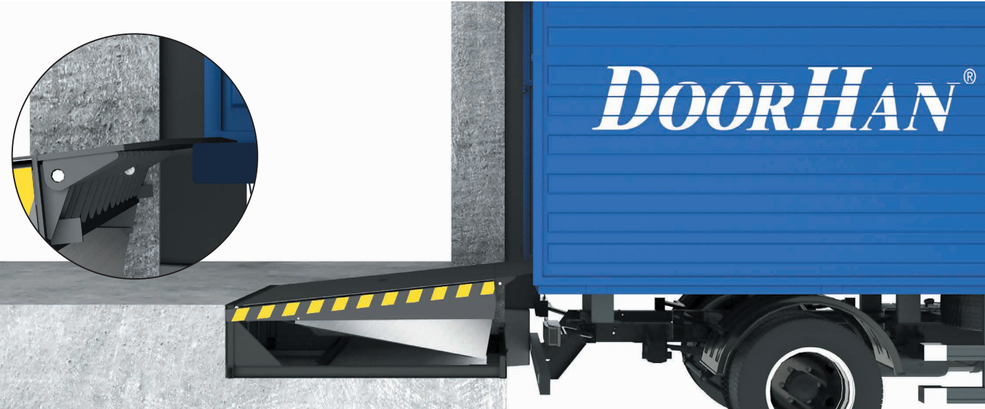
弯曲型舌板在仓库地面低于卡车车厢的情况下推荐使用
